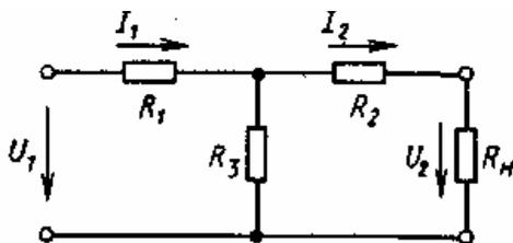
Цепь, схема замещения которой представлена на рисунке, является Т-образной схемой четырехполюсника. Найти постоянные и составить уравнения четырехполюсника, если сопротивления резисторов равны  $R_1$ ,  $R_2$ ,  $R_3$ . Определить величину согласованной нагрузки.
