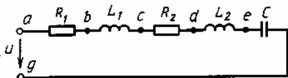
В цепь синусоидального тока включены последовательно две катушки и конденсатор. Параметры катушек и конденсатора известны:  $R_1, L_1, R_2, L_2, C$ . Кроме того, известна ЭДС  $E_{L1}$ . Найти напряжение источника, полную активную и реактивную мощности цепи, сдвиги фаз на участках  $ac$  и  $ce$ .
