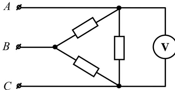
12. Трехфазная сеть, питающая симметричный потребитель, имеет линейное напряжение  $U = 24$  В. Что покажет вольтметр, подключенный к фазе CA, если провод B оборван?
