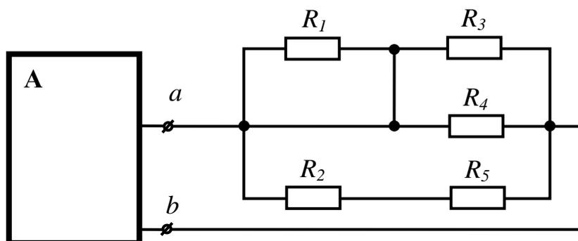
2. Определить сопротивление нагрузки активного двухполюсника.  $R_1=30, R_2=30, R_3=30$ .
